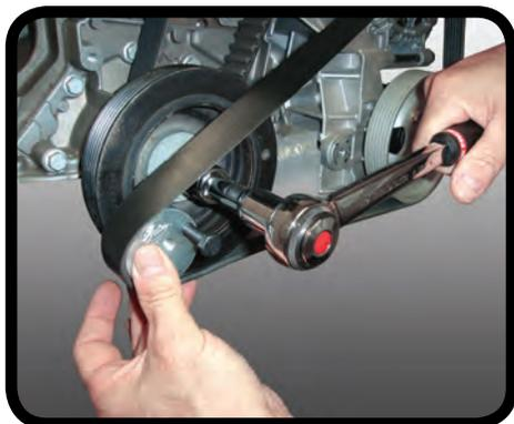
En apparence, les courroies Stretch Fit peuvent sembler identiques aux courroies à rainures en V standard; leur conception est toutefois entièrement différente. Le secret réside dans la technologie TwistLock de ACDelco. Cette technologie de pointe allie la résistance et la flexibilité des cordes de traction en polyamide à la puissance d'un adhésif spécialement formulé qui enveloppe les cordes, de manière à ce qu'elles puissent s'allonger et s'ajuster sans jamais perdre de tension.
